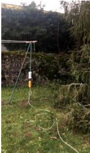
Trop près d'un arbre et champ obstrué en partie par le piquet
