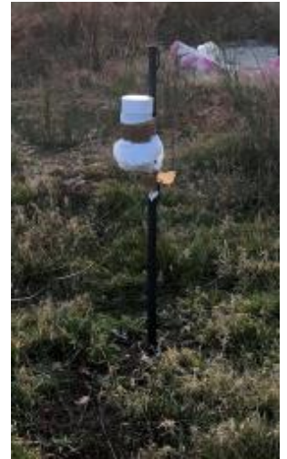
Champ du Ninox partiellement obstrué par le haut du piquet
