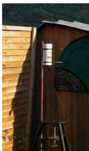
Ninox suffisamment surélevé pour ne pas être gêné par le toit
