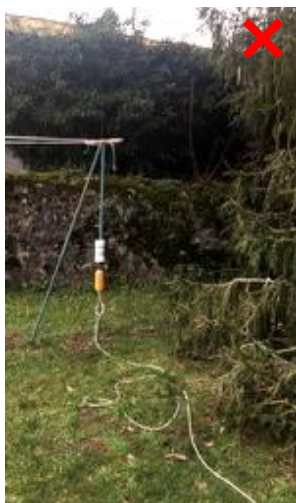
Trop près d'un arbre et champ obstrué en partie par le piquet de l'étendoir
