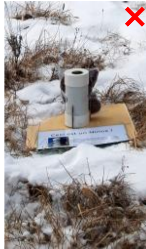
Trop près du sol avec un risque que l'humidité pénètre dans le boîtier
